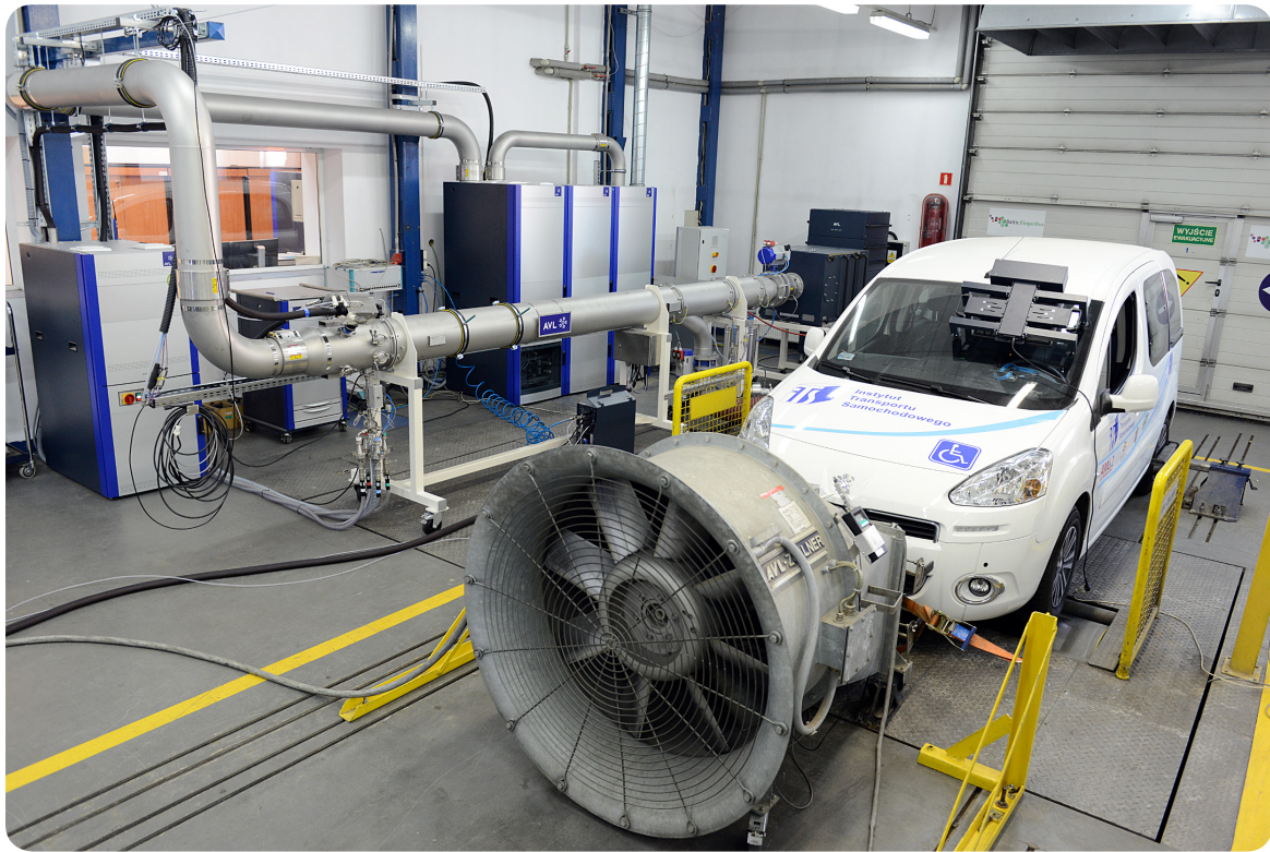
Rys. 13. Widok stanowiska hamowni podwoziowej
