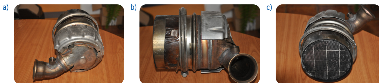
Rys. 15. a), b), c) Filtr cząstek stałych usunięty z Peugeota Partnera
