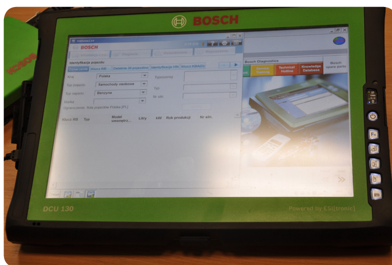
Rys. 12. Przyrząd firmy BOSCH typ KTS do odczytu wyników z systemu EOBD
